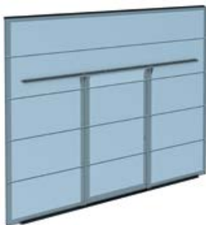
Калитка с плоским порогом 20 мм
